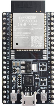
Gambar 2. 1 Mikrokontroler ESP32
