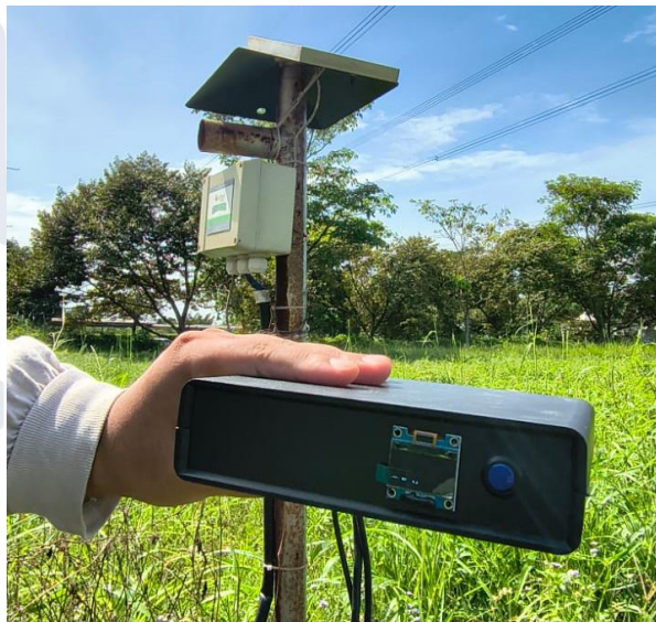
Gambar 4. 13 percobaan perbandingan akurasi perangkat pada lahan kangkung di BRMP.
